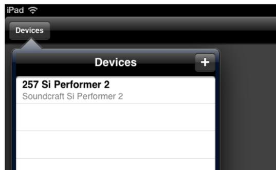
Durch Antippen des Pultes in der Device-List, wird nach wenigen Sekunden das Pult verbunden und kann ferngesteuert werden. Wichtig: nur wenn unten rechts die „LED“ grün ist, ist das Pult wirklich online.
